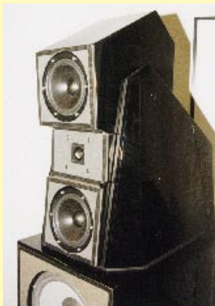
Bild 4 Das Gehäuse ist in vier Module aufgeteilt. Der horizontale Versatz wird dem Hörplatz zur phasenrichtigen Addition der Einzeltreiber angepasst.
